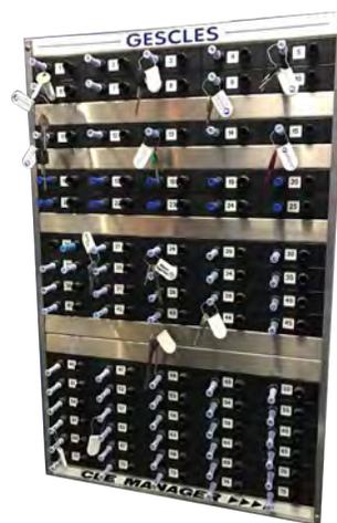
Sur la base d'un CLÉ MANAGER 100, 5 barres d'espacement ont été ajoutées pour les cas de "gros trousseaux". Sur une capacité initiale de 100, ce CLÉ MANAGER possède une capacité de 75 emplacements pour les clés.
